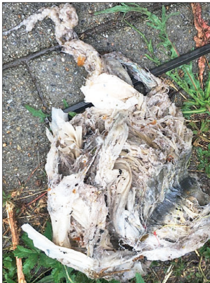
(Foto: Zellstoff- und Viskoseknoten mit Plastik und Möhre)
